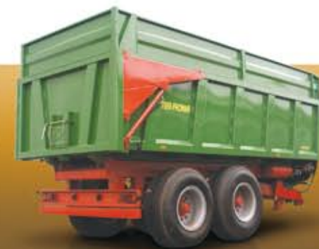
Układ jezdny z osią kierowaną biernie. W czasie jazdy do przodu koła osi kierowanej ustawiają się zgodnie z kierunkiem jazdy, natomiast w czasie cofania koła blokowane są jak do jazdy na wprost
