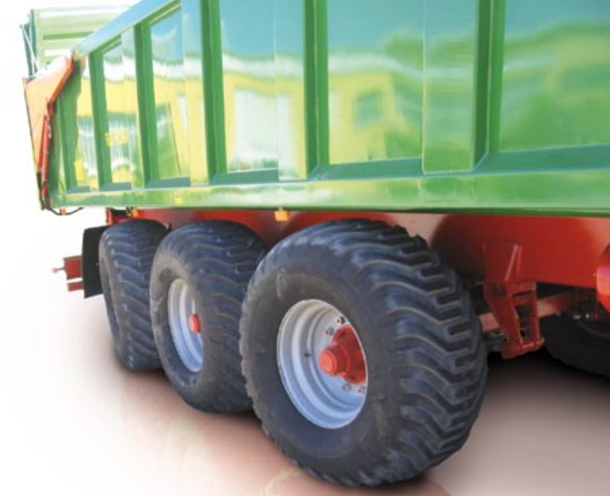
Układ jezdny typu tridem z pierwszą i trzecią osią kierowaną biernie. W czasie cofania skręt kół blokowany jest siłownikami hydraulicznymi
