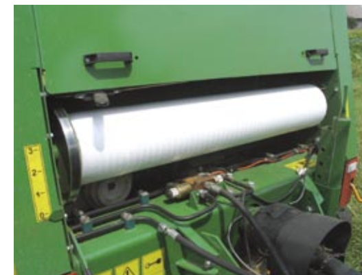
Wyposażenie specjalne (na życzenie klienta) - układ owijania siatką. Opcjonalnie można zamontować w prasie układ owijania siatką. Taki system znacznie skraca czas owinięcia, co zwiększa wydajność oraz zmniejsza czas i ułatwia odwijanie sprasowanego materiału
