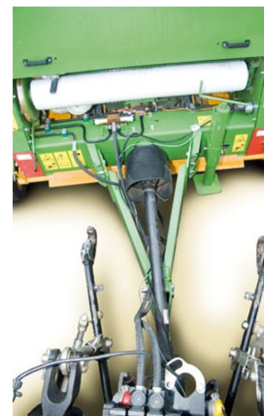
Wał przegubowo-teleskopowy szerokokątny. Prasę agreguje się z ciągnikiem za pomocą wału przegubowo-teleskopowego szerokokątnego. Takie rozwiązanie umożliwia robienie nawrotów bez potrzeby wyłączania wałka WOM. Przy standardowych wałach przegubowo-teleskopowych groziłoby to uszkodzeniem wału lub znacznym obniżeniem jego żywotności
