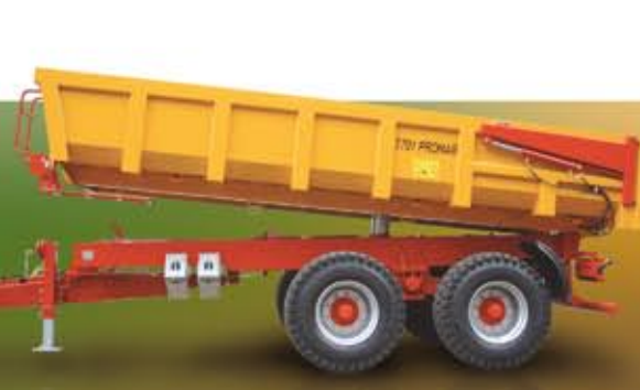
Układ jezdny z osią kierowaną biernie. W czasie jazdy do przodu koła osi kierowanej ustawiają się zgodnie z kierunkiem jazdy, natomiast w czasie cofania koła blokowane są jak do jazdy na wprost
