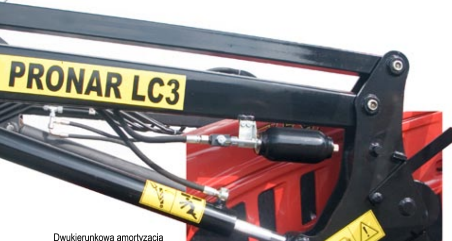
Dwukierunkowa amortyzacja wysięgnika
