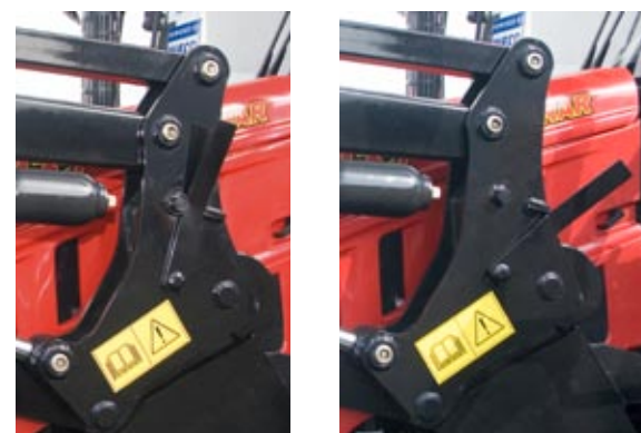
System szybko mocujący sprawnie i pewnie podłącza ładowacz
