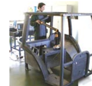
W wyniku wykonanego pomiaru konstrukcji ochronnej (zdjęcie obok) otrzymujemy na monitorze komputera następujący obraz (zdjęcie poniżej). W tym przypadku zastosowano metodę odwrotnego odwzorowania z wykorzystaniem funkcji „grupa kontroli powierzchni”
