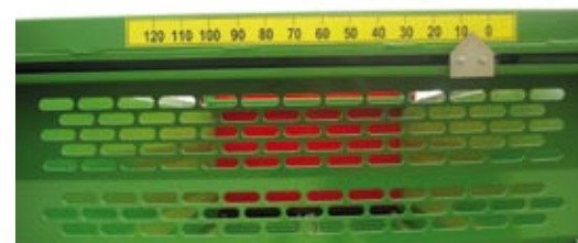
Znajdujący się na ścianie przedniej czytelny wskaźnik informuje o dokładnym położeniu zasuw rozrzutnika
