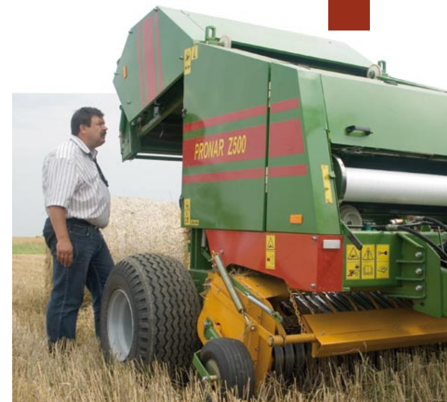
Wyposażenie specjalne (na życzenie klienta) - układ owijania siatką. Opcjonalnie można zamontować w prasie układ owijania siatką. Taki system znacznie skraca czas owinięcia, co zwiększa wydajność oraz zmniejsza czas i ułatwia odwijanie sprasowanego materiału
