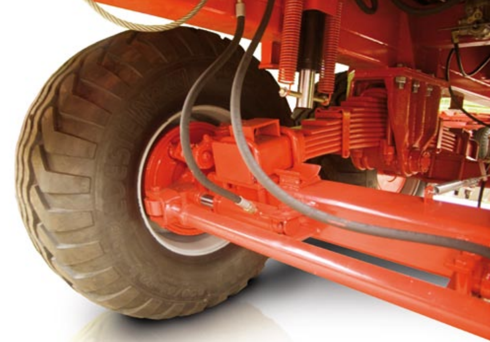
Siłowniki hydrauliczne zamontowane na osi umożliwiają blokowanie kół w czasie cofania jak do jazdy na wprost. Siłowniki hydrauliczne zasilane są z układu hydraulicznego ciągnika
