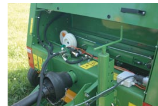
Obwiązywacz sznurkiem podwójnym. Prasa w standardzie wyposażona jest w obwiązywacz sznurkiem podwójnym. W odróżnieniu od obwiązywaczy sznurkiem pojedynczym to urządzenie znacznie skraca czas obwiązania balotu, co w efekcie zwiększa wydajność prasy. Obwiązywacz posiada także trzystopniową regulację gęstości owinięcia, umożliwiającą optymalny dobór ilości owinięć do zbieranego materiału
