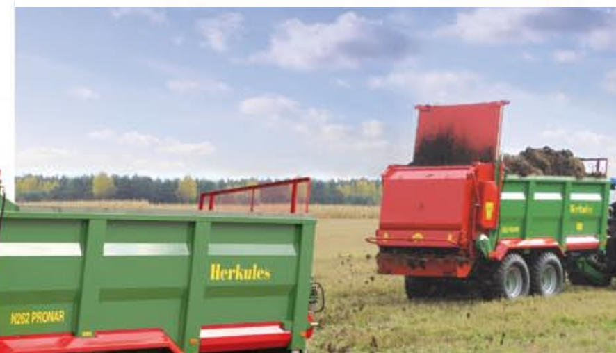
Adapter rozrzucający precyzyjnie i równomiernie rozrzuca różnego rodzaju nawozy na szerokość od 12 do 25 metrów
