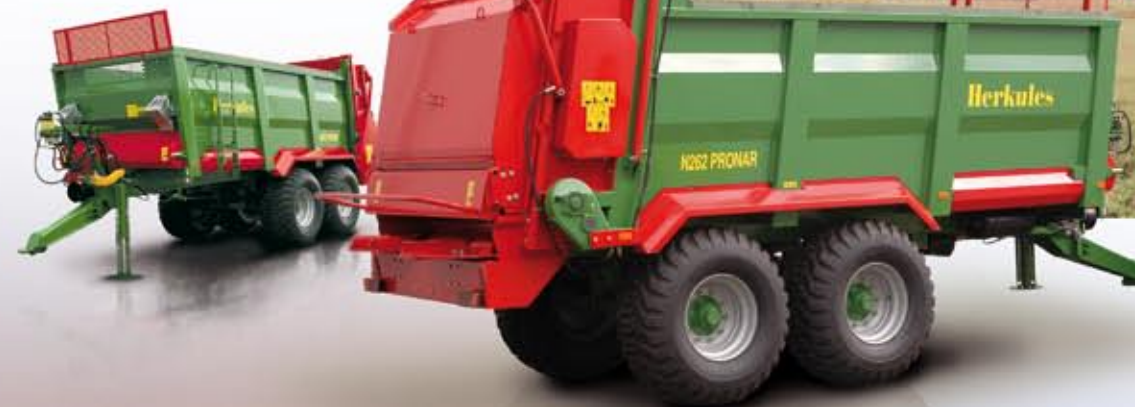
Herkules 12 o pojemności skrzyni 11,3 m 3 i ładowności 12 ton
