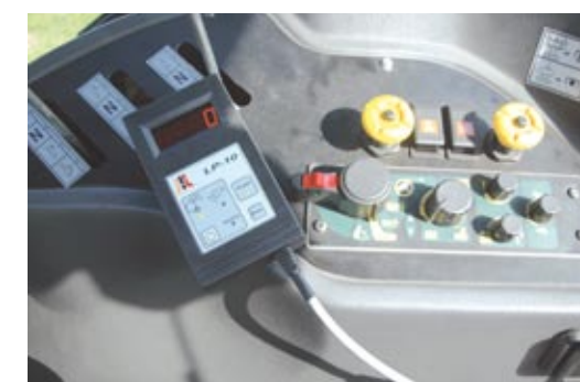
Pulpit sterowniczy prasy. Sterowanie prasą, tj. podnoszenie i opuszczanie podbieraka, załączanie układu owijania sznurkiem lub siatką i otwieranie komory (wyladunek balotu) realizowane jest z kabiny ciągnika za pośrednictwem pulpitu sterowniczego. Mocowany jest on w ciągniku za pomocą przysawki. Takie rozwiązanie ułatwia operatorowi obsługę prasy bez potrzeby wysiadania z kabiny ciągnika
