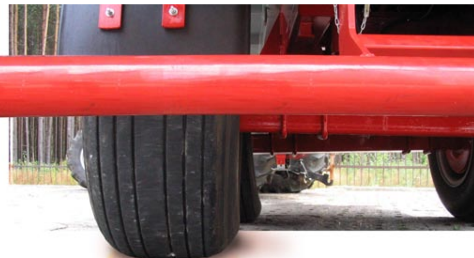
Przyczepa z dwiema osiami skrętnymi, w czasie skręcania opony jednej osi przesuwane są w bok po podłożu co powoduje ich przyspieszone zużycie się
