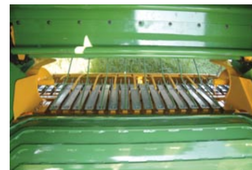
Dociskacz z blachą odbojową i grabie dozujące. Elementy te odpowiadają za równomierne podawanie zbieranego materiału do komory prasy. Równomierne ułożenie materiału w beli zapewnia prawidłowe zakiszenie i lepsze przechowywanie
